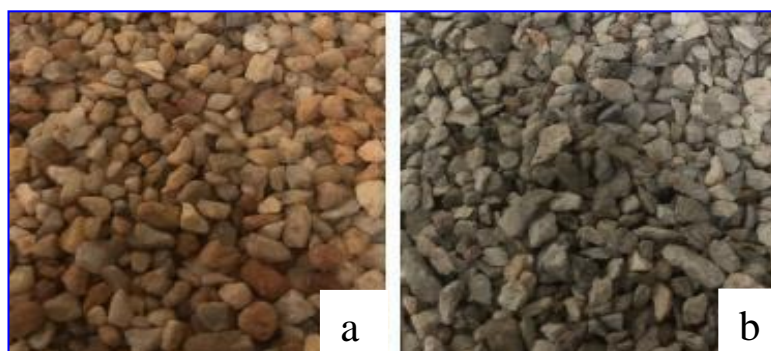
Figura 5 – Agregados: (a) seixo e (b) concreto reciclado
